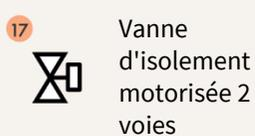
Vanne d'isolement motorisée 2 voies
